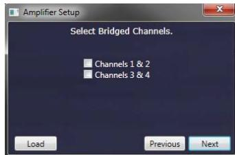
Elija conectar los canales si ambos se usan para conducir una carga común.
