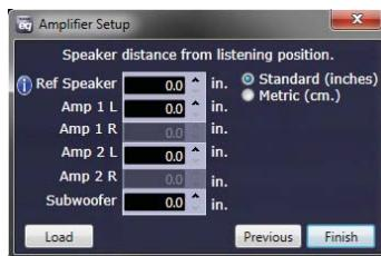
Legen Sie den Abstand der Lautsprecher von der primären Hörposition fest. Die korrekte Zeitverzögerung der Lautsprecher wird automatisch konfiguriert, um die beste Tonbühne sicherzustellen. Die Einstellung Referenzlautsprecher sollte gewählt werden, wenn ein Lautsprecher verwendet wird, der nicht mit dem aktuellen Verstärker verbunden und am weitesten von der Hörposition entfernt ist.
