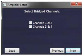
Überbrücken Sie die Kanäle, wenn beide Kanäle eine normale Last unterstützen.
