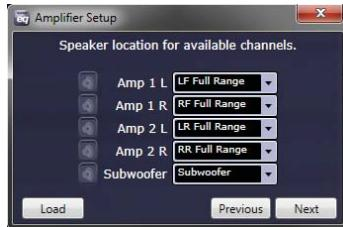
Seleccione el tipo de conductor utilizado por cada canal. Esto ayudará al software TWEEQ a configurar automáticamente el divisor de frecuencia. Consulte la página 23 para ver el gráfico de referencia.
