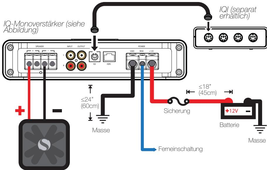
Verwenden Sie 16GA oder größere Kabel, um Ihre Lautsprecher mit dem IQ-Verstärker zu verbinden. Verbinden Sie den Ausgang der Quelleinheit mit den RCA-Eingängen des IQ-Verstärkers. Verwenden Sie die IQ RCA-Ausgänge, um das Signal an einen anderen Verstärker zu übergeben.
