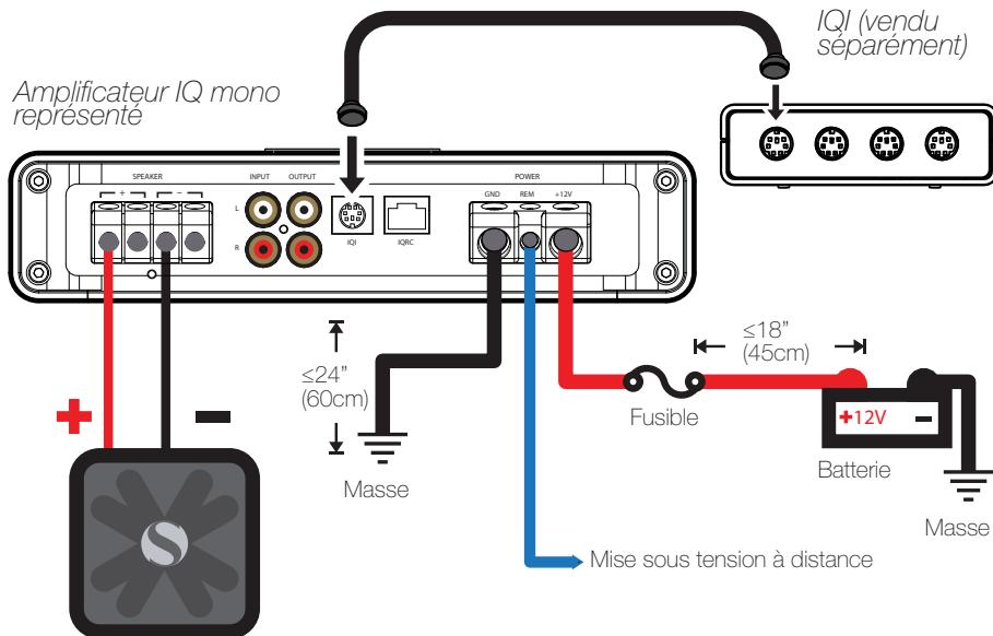
Connectez vos enceintes à l'amplificateur IQ avec des câbles de 1,3 mm<sup>2</sup> (16GA) ou plus gros. Connectez la sortie de votre appareil source aux entrées RCA de l'amplificateur IQ. Utilisez les sorties RCA de l'IQ pour transmettre le signal à un autre amplificateur.
